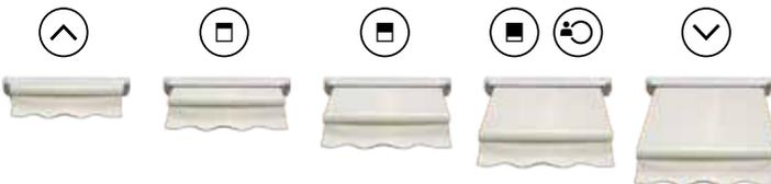
Cuenta con 6 posiciones de parada en los motores R4 (subida, bajada, punto medio y 3 intermedias) o solo 2 para los receptores (subida y bajada)
